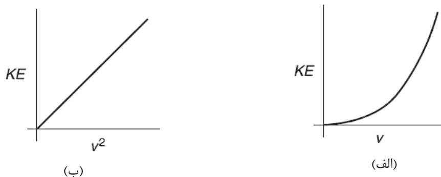
شکل (۶) (الف) نمودار انرژی جنبشی بر حسب سرعت، (ب) الف نمودار انرژی جنبشی بر حسب مجذور سرعت
