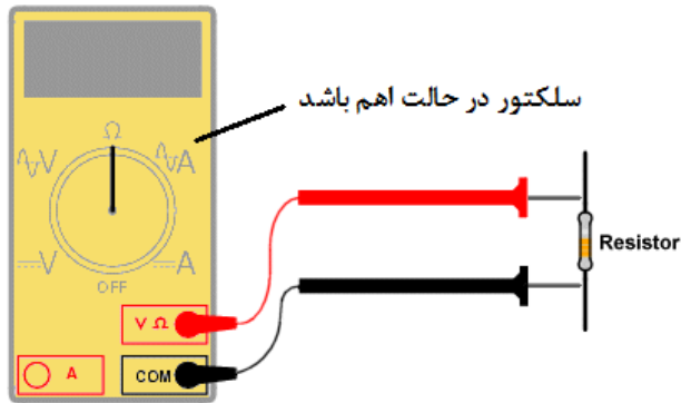
شکل (۵۴) اندازه‌گیری مقاومت با مولتی متر
