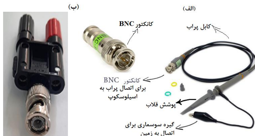
شکل (۶۳) سمت راست (الف) پراب غیرفعال همراه با کانکتور BNC و در سمت چپ (ب) کانکتور BNC آزمایشگاه فیزیک ۲
