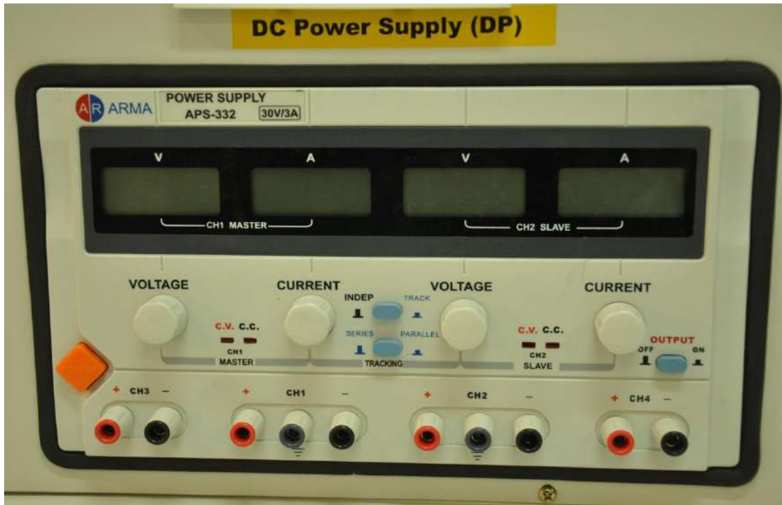
شکل (۴۰): تصویری از منبع تغذیه مستقیم نصب شده روی میز الکترونیکی
