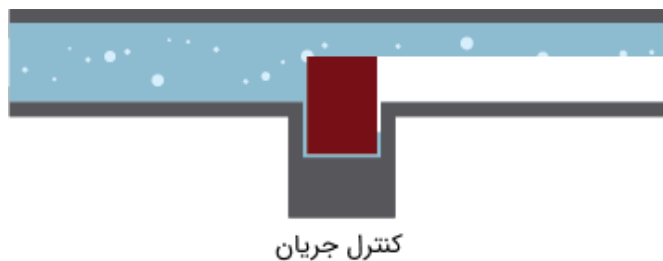
شکل (۳۳): طرحواره تشبیه شرایط کنترل جریان ترانزیستور به شیر نیمه باز
