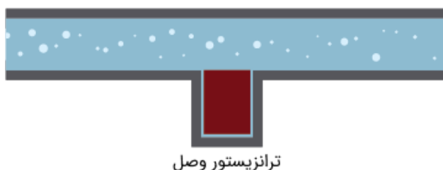
شکل (۳۱): طرحواره تشبیه شرایط اتصال کوتاه ترانزیستور به شیر کاملاً باز
