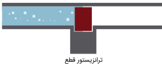
شکل (۳۲): طرحواره تشبیه شرایط مدار باز ترانزیستور به شیر کاملاً بسته
